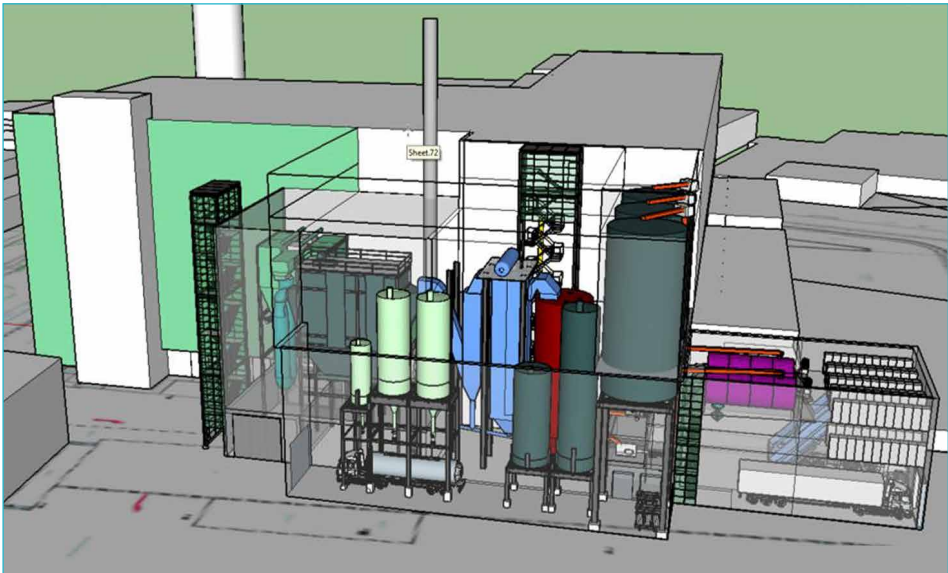
Bild 5: Modell der Klärschlammverwertungsanlage am Standort der MVA Bonn – Seitenansicht
