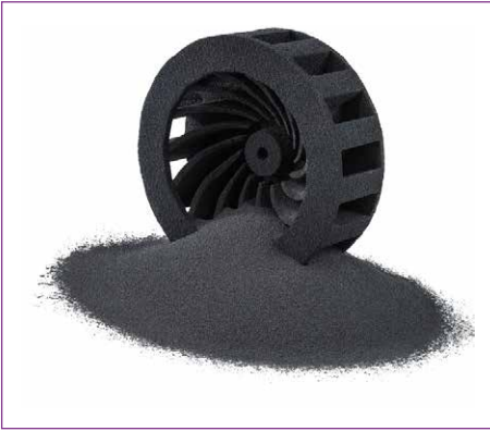
Bild 2: Kohlenstoff-Pulver als Ausgangsmaterial und ein mittels Binder-Jetting-Verfahren gedrucktes Bauteil
