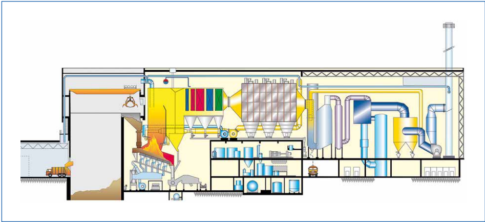
Bild 1: Beispiel einer High SO x Schaltung: KVA Thun, Schweiz
