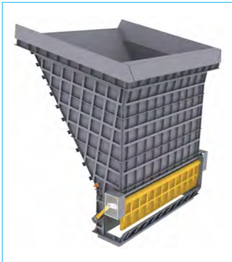
Bild 7: Brennstoffaufgabetrichter inklusive Absperrklappe
