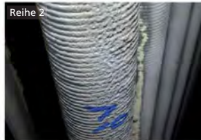
T_{RG}/T_{Of} = 685^{\circ}\text{C}/470^{\circ}\text{C} , flächige Abzehrung überlagert von Mulden
