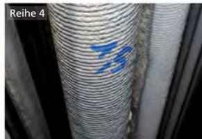
T_{RG}/T_{Of} = 675^{\circ}\text{C}/475^{\circ}\text{C} , flächige Abzehrung überlagert von Mulden
