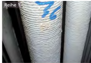
T_{RG}/T_{Of} = 690^{\circ}\text{C}/460^{\circ}\text{C} , flächige Abzehrung
