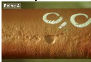
T_{RG}/T_{Of} = 745^{\circ}\text{C}/445^{\circ}\text{C} , flächige Abzehrung überlagert von Mulden und Rillen
