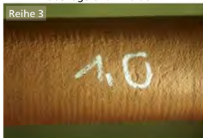
T_{RG}/T_{Of} = 750^{\circ}\text{C}/435^{\circ}\text{C} , flächige Abzehrung überlagert von Mulden
