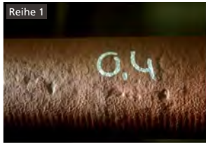
T_{RG}/T_{Of} = 760^{\circ}\text{C}/430^{\circ}\text{C} , flächige Abzehrung einzelne tiefe Mulden
