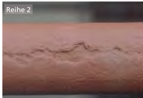
T_{RG}/T_{Of} = 755^{\circ}\text{C}/440^{\circ}\text{C} , flächige Abzehrung überlagert von Mulden
