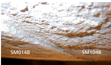
Bild 2: Unterschiedlicher Angriff durch Alkaliangriff an SiC-Betonen
