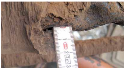
Bild 4: Staubanlagerung bei einem Rohr mit Nebenform nach Erprobung hinter einem metallurgischen Prozess und Reinigungswirkung durch Klopfen
