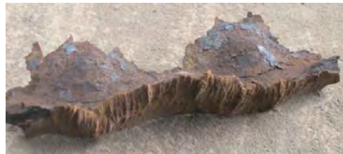
Bild 4: Staubanlagerung bei einem Rohr mit Nebenform nach Erprobung hinter einem metallurgischen Prozess und Reinigungswirkung durch Klopfen
