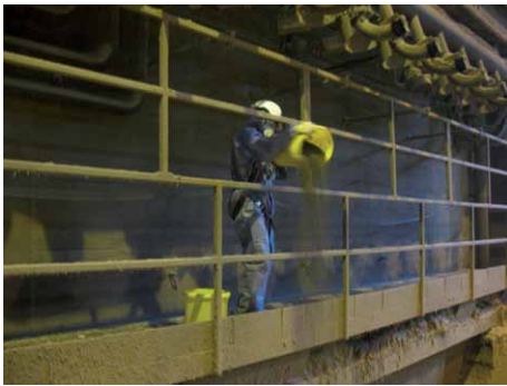
Bild 8: Zugabe des Filteraschekuchens in die Abfallschurre
