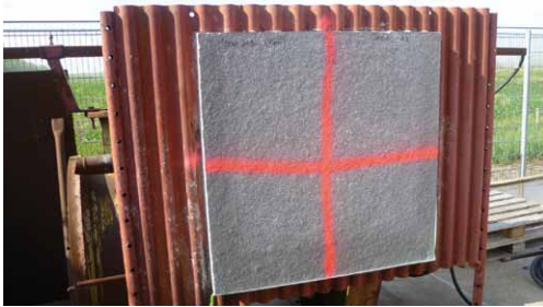
Bild 9: Mit Feuerfestbeton zugestellte Testwand
