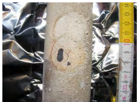
b) Abplatzungen und Risse – Sonde Nr. 2
