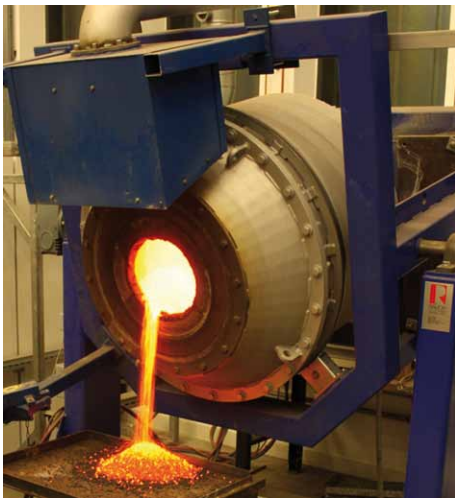
Bild 5: Entleerung des Top Blown Rotary Converters
