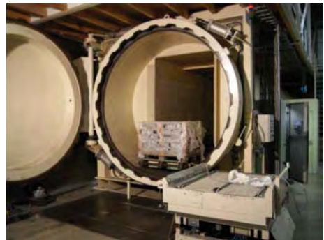
Bild 6: Fertigteile aus Edelstahlschlacke nach der Autoklavierung (links) und industrieller CO 2 -Autoklave (rechts)
