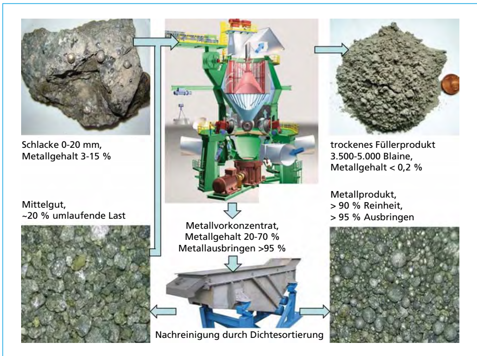
Bild 3: Produkte der Schlackemahl- und Sortiereinrichtung nach dem System Loesche
