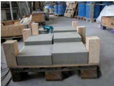
Bild 6: Fertigteile aus Edelstahlschlacke nach der Autoklavierung (links) und industrieller CO 2 -Autoklave (rechts)
