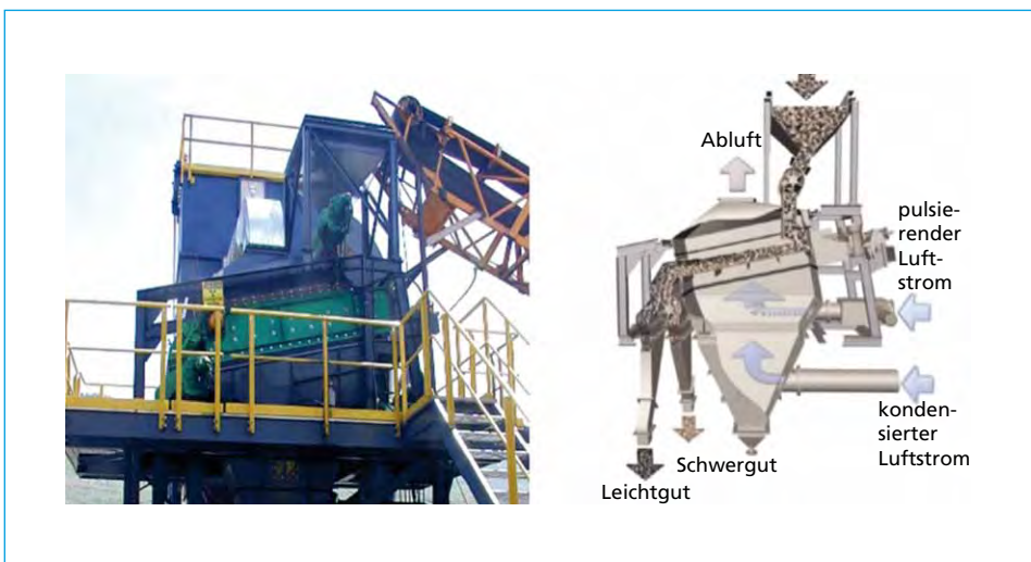
Bild 2: Luftsetzmaschine Typ Allair, Fa. Allmineral
