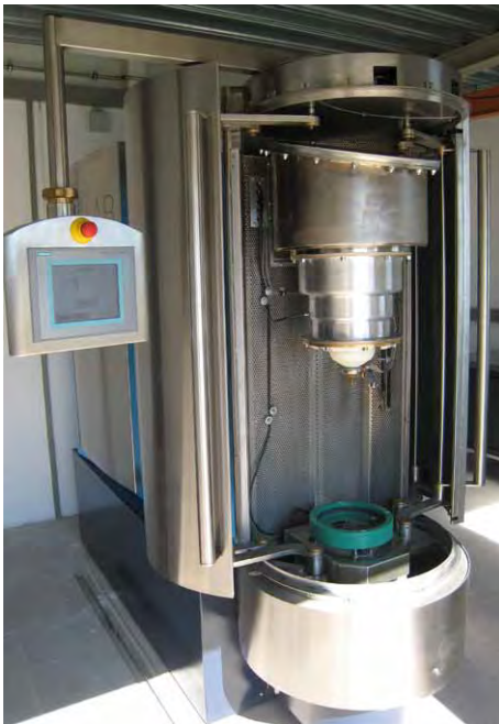
Bild 6: Laboranlage zur elektrodynamischen Fragmentierung am Fraunhofer-Institut für Bauphysik (IBP)
