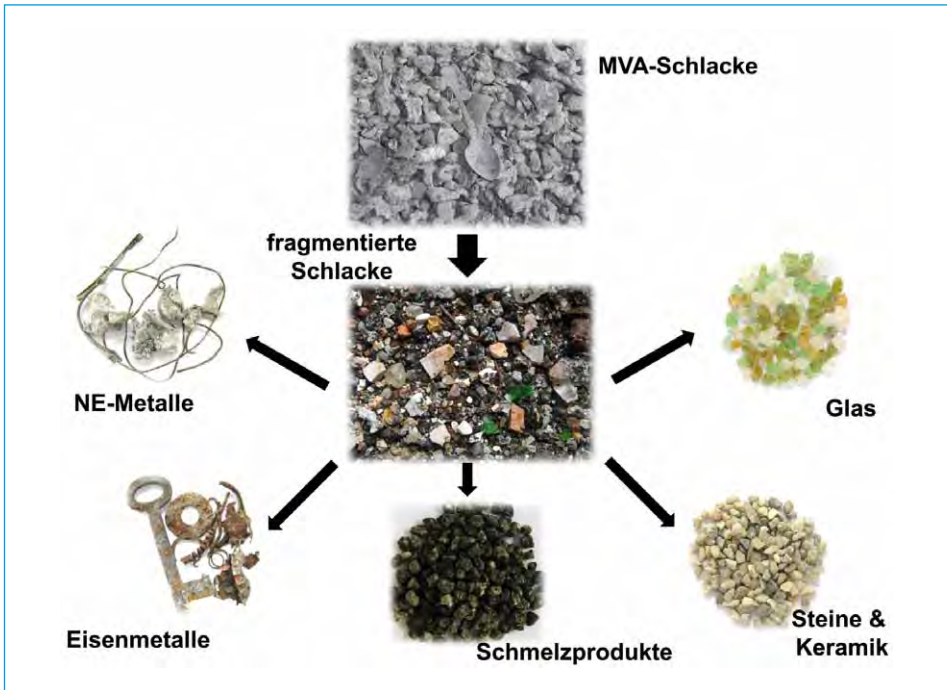
Bild 7: Die fünf Stoffgruppen einer ausgewählten fragmentierten MVA-Schlacke
