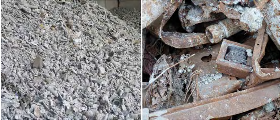
Bild 1: MVA-Schlacke nach Abtrennung von Grobschrott und Eisenmetallen durch Magnetscheidung (links), abgetrennter Grobschrott (rechts)
