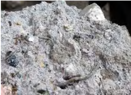
Bild 2: Mit silikatischer Matrix verbundene MVA-Schlacke
