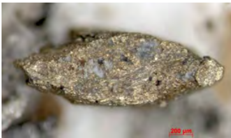
Bild 2: Kupfer/Messingpartikel mit Einschlüssen aus MVA-Schlacke (Aufnahme mit Stereomikroskop)
