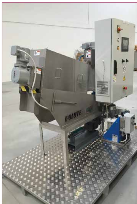
Bild 3: Beispiel einer Schneckenpresse mit einem Durchsatz 6 kg TS/h aerob stabilisierten Schlamms
