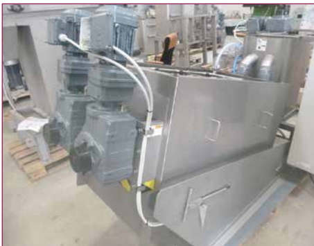
Bild 4: Für den Kostenvergleich zu Grunde gelegte eigene Schneckenpresse vom Typ Volute FS-202
