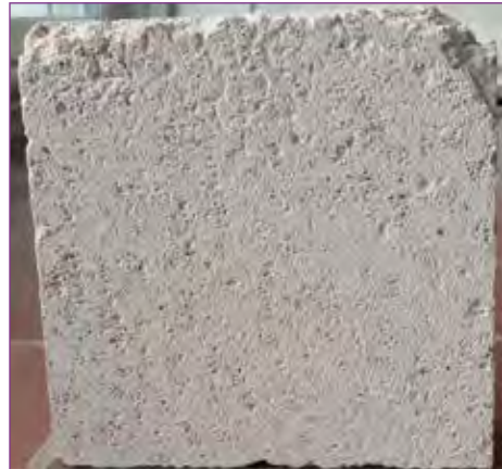
Bild 13: Variante 3; Primär-Granulate 8/16 vorgeschlämmt, kaum Unterscheidung zwischen eingebrachten Granulaten und Schaummörtelmatrix möglich; Probenbreite 15 cm
