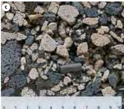
RC-Granulate 4/32 ausgleichsfeucht; Haufwerksporenraum blieb in weiten Bereichen unverfüllt
