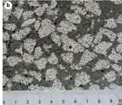
Primär-Granulate 8/16 vorgehäst; Haufwerksporenraum nahezu vollständig mit intaktem Schaummörtel gefüllt
