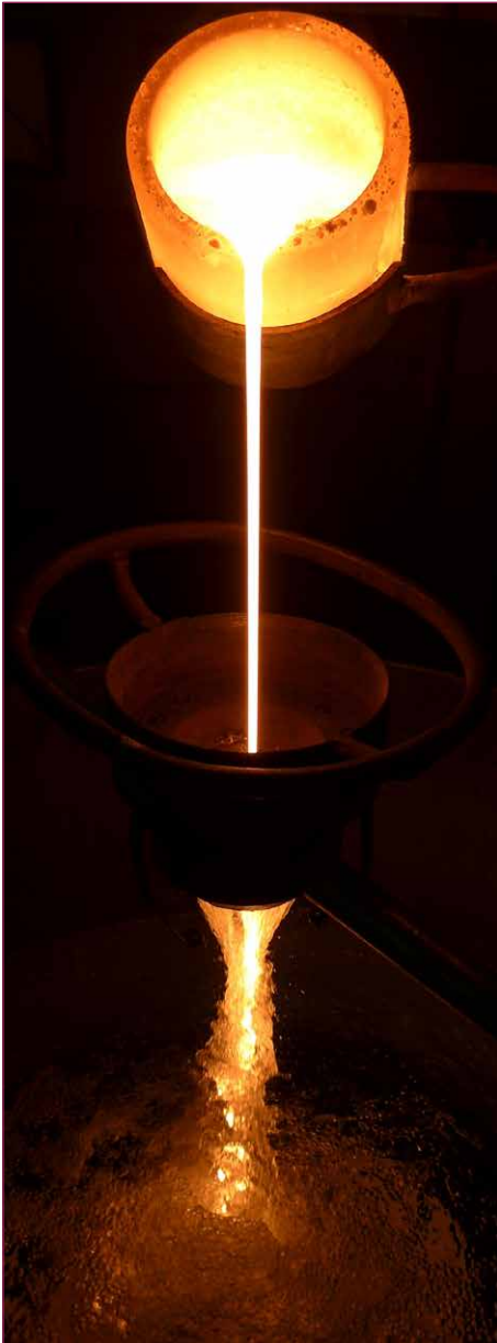
Bild 3: Wassergranulation von Schlacke im Schmelzlabor des FEhS-Instituts
