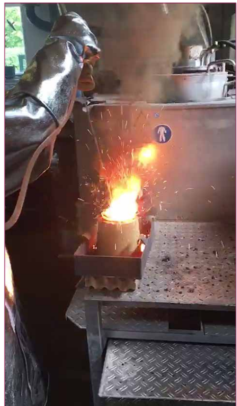
Bild 5: Aufblasen von Sauerstoff auf phosphorangereichertes Roheisen
