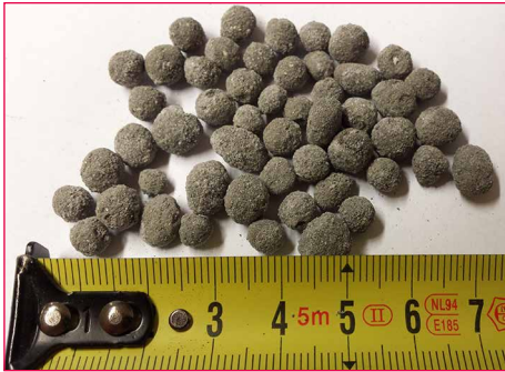
Bild 2: Erzeugte Pellets mit Maßstab; Zielgröße etwa 8 mm
