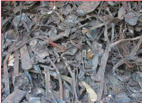
Bild 7: Eisen aus Trockenschlacke
