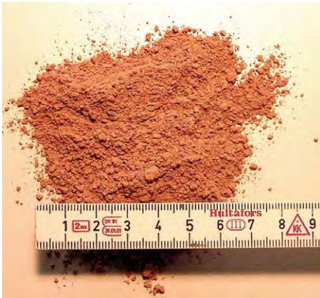
Bild 5: Mit einer Kugelmühle zerkleinertes Mauerwerksbruch
