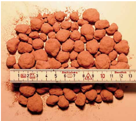
Bild 6: Grüngranulate nach dem Agglomerationsprozess mit einem Tellergranulator
