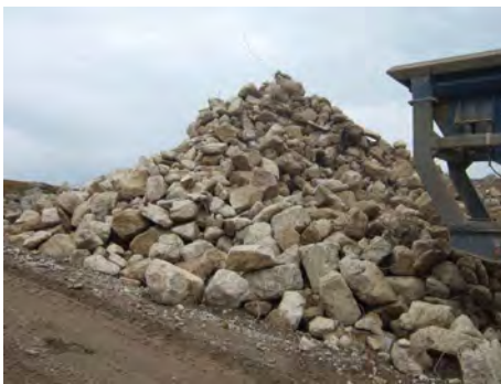
Bild 1: Altbetonhalde – Ausgangsmaterial für eine Gesteinskörnung nach Typ 1
