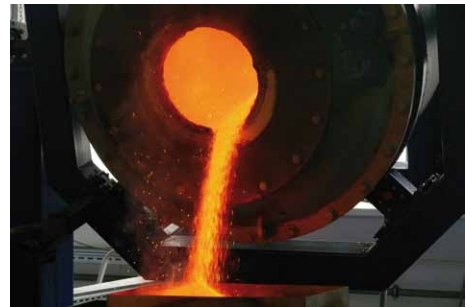
Bild 7: Entleerung des geklinkerten Materials bei Prozessende
