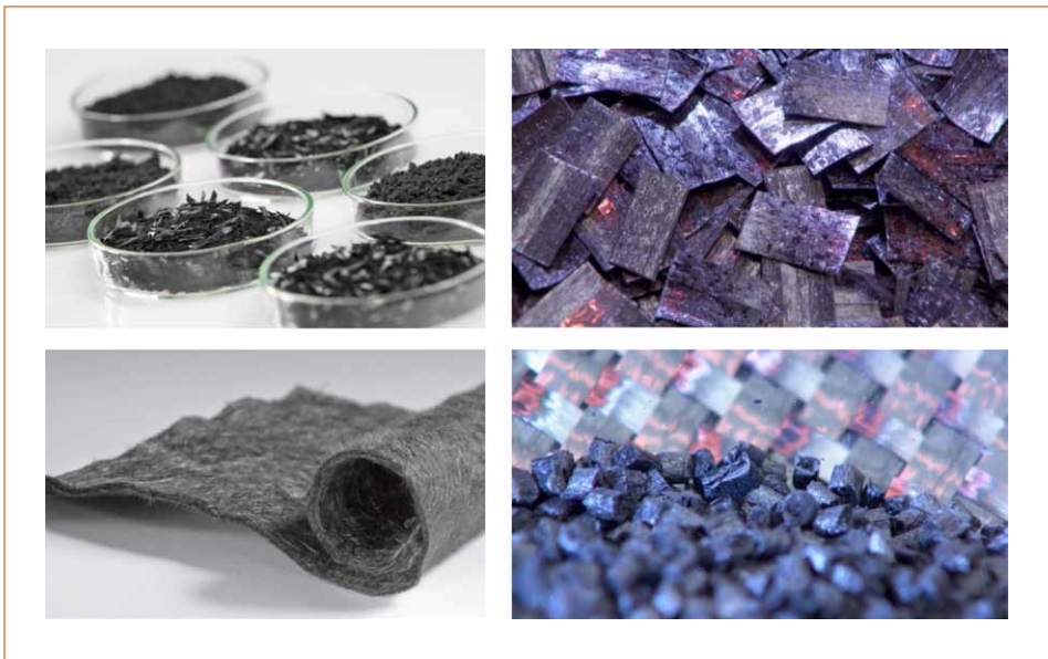
Bild 7: CFK Recyclingprodukte. Oben links: geschnittene und gemahlene Fasern. Oben rechts rCFK-Pellets. Unten links: rCFK-Vlies. Unten rechts: Geschnittene Fasern
